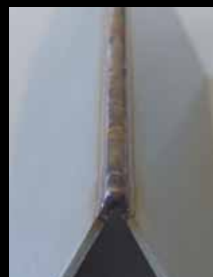
Идеальная сварка угловых швов в высокочастотном пульсе TIG DC
