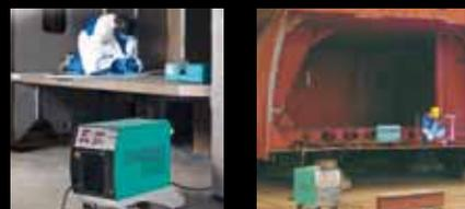
Процесс Merkle DeepARC - образование узкой стреловидной дуги в результате высокочастотного регулирования напряжения. Процесс обеспечивает глубокий провар и высокую скорость сварки. Эффективен для сварки всех видов стали и алюминия. Режим сварки DeepARC присутствует на аппаратах Merkle серии HighPULSE и SpeedMIG!
