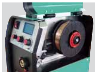
Упрощенная система смены катушки проволоки (D200 / 5kg)
