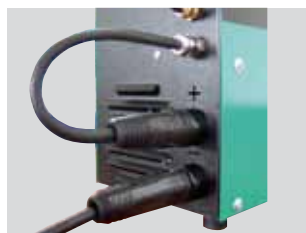
Быстрая смена полярности для сварки безгазовой проволокой
