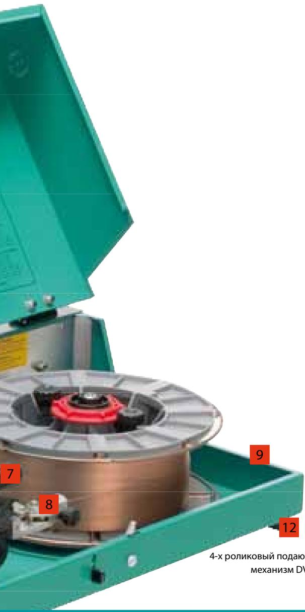
4-х роликовый подающий механизм DV-31.
