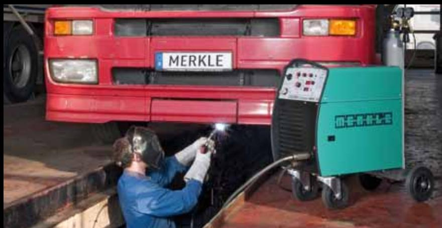
Удобство удаленного управления сваркой при помощи горелки с системой TEDAC.
