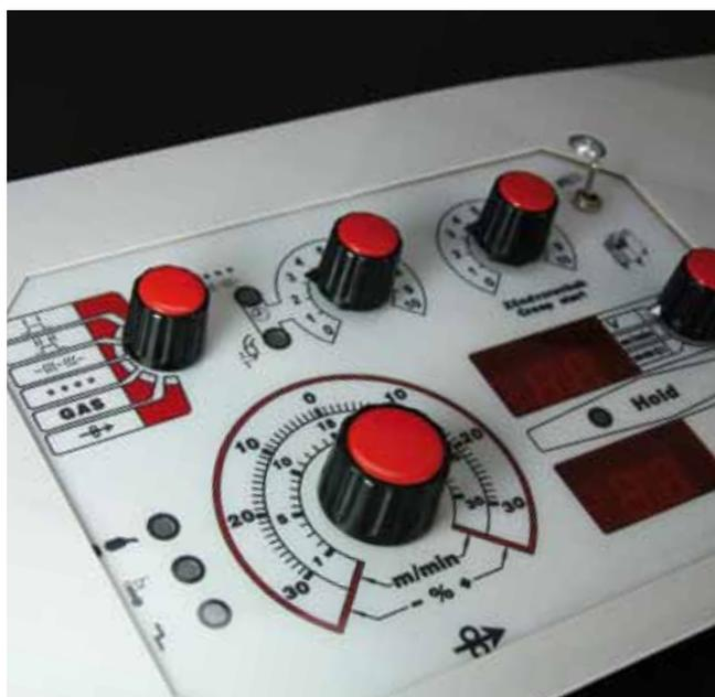
Простота настройки благодаря большим ручкам и цифровому дисплею (CompactMIG 220/280/400).
